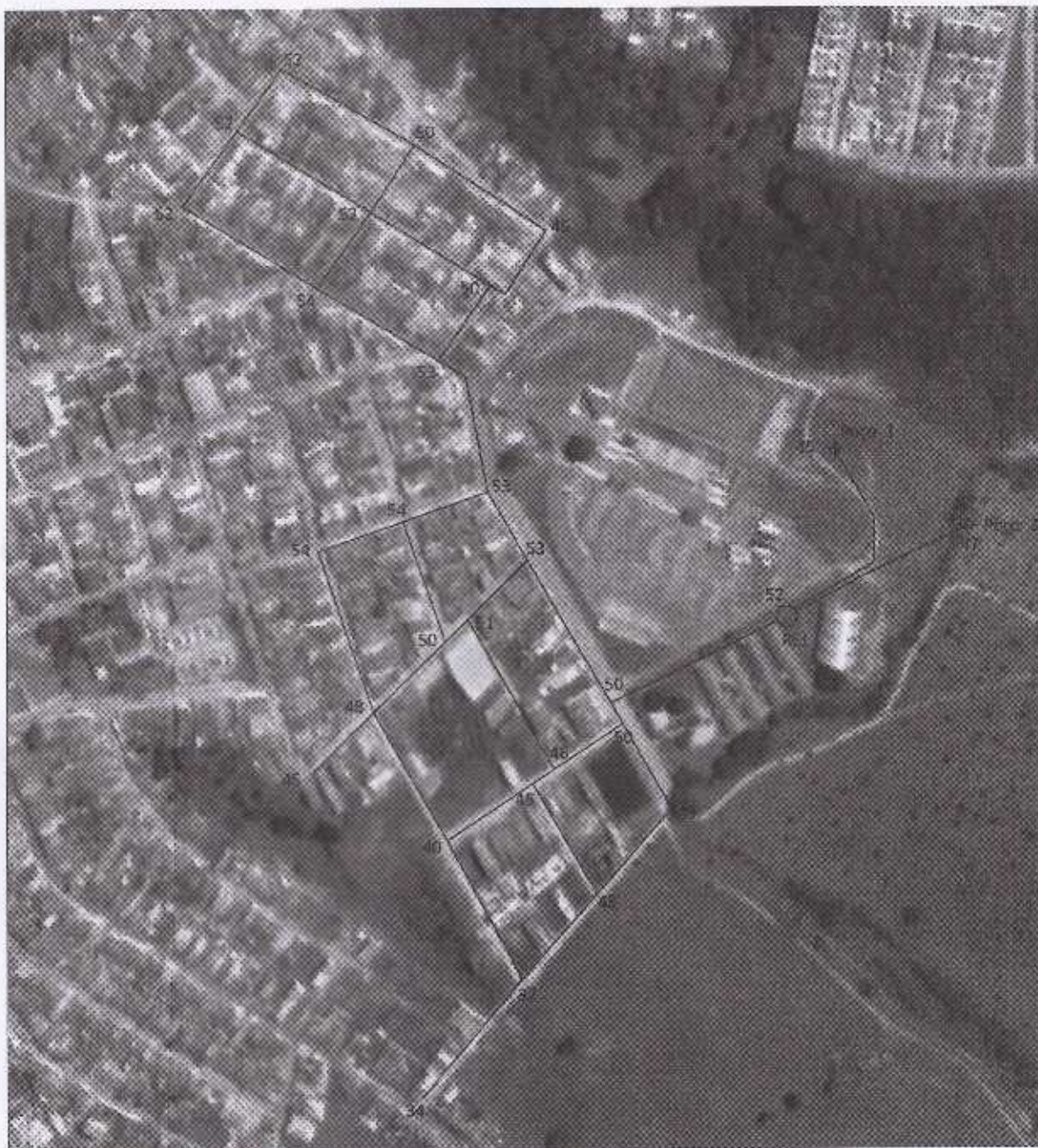
Figura 3 – Rede de distribuição de água para pré-dimensionamento e cotas do terreno – Loteamentos São Jorge e São Paulo – Imagem de satélite do Google Earth®.
